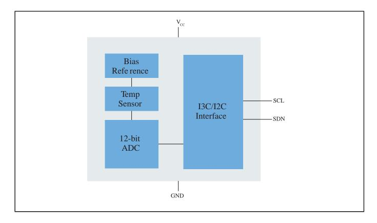
View additional information for I3C/I2C/バスに対応した±2.0°C精度のデジタル温度センサ.
