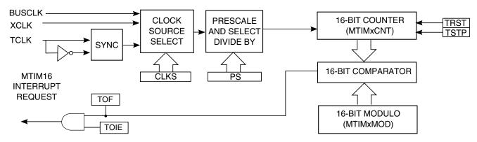
Figure 35-1. Modulo Timer (MTIM16) Block Diagram
