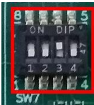
图 9. QSPI Flash 引导模式配置
