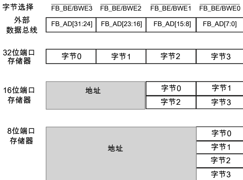
图 6. 连接外部存储器端口尺寸(CSCRN[BLS] = 1)
