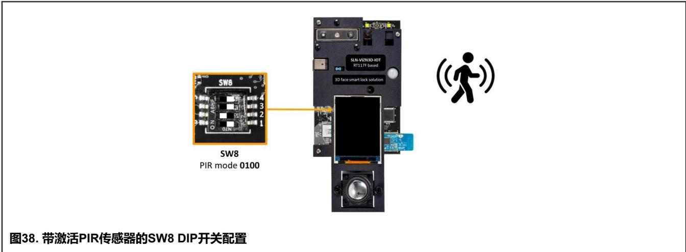
图38. 带激活PIR传感器的SW8 DIP开关配置
